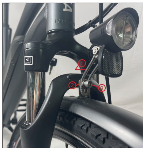
1 - Staffa supporto faro anteriore 2 - Supporto parafango posteriore 3 - Bullone di fissaggio a brugola
